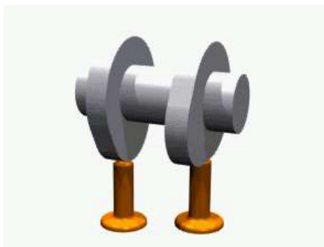
Σχήμα 22: Έκκεντρα εκκεντροφόρου άξονα, με τη μία βαλβίδα να έχει ήδη ανοίξει [22]
